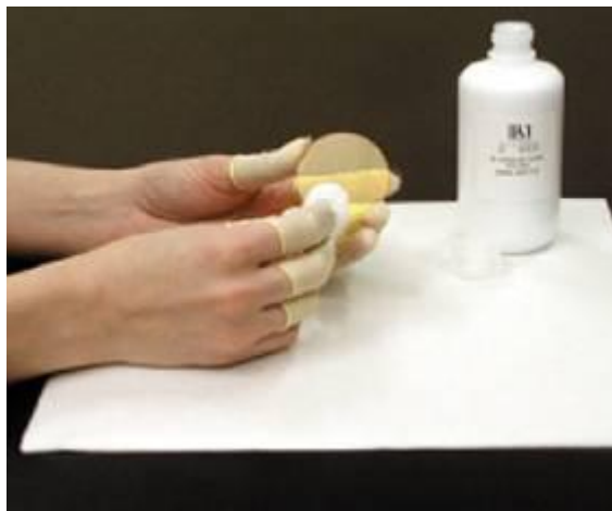
图 8-4 聚焦镜严重污染的清洁
