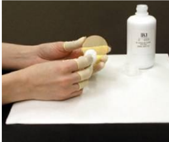
图 8-4 聚焦镜严重污染的清洁
